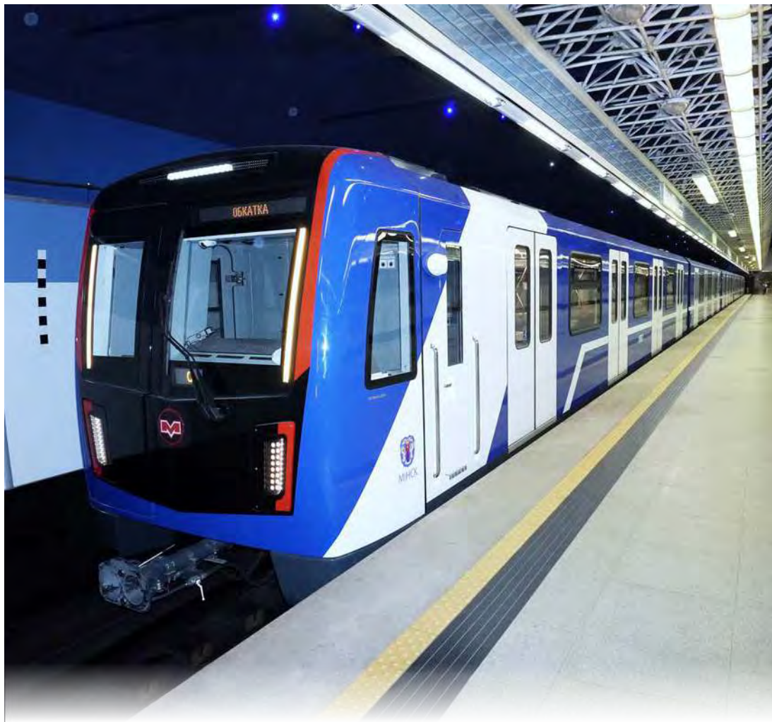
ЭЛЕКТРОПОЕЗД МЕТРОПОЛИТЕНА С АСИНХРОННЫМ ТЯГОВЫМ ПРИВОДОМ МОДЕЛИ M110
